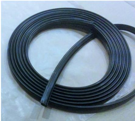
R16 – joint caoutchouc de capot de coffre
