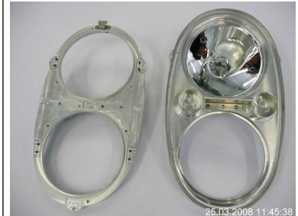
**C21 -** Platine support paraboles Mégalux
